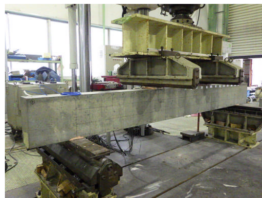
図-6.32 曲げ載荷試験状況
