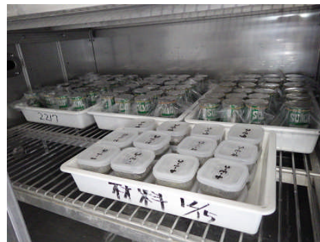
図-3.5 試験体の養生状況
