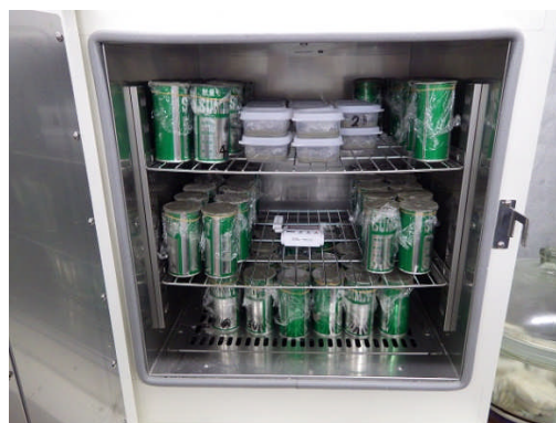
図-4.4 試験体の養生状況
