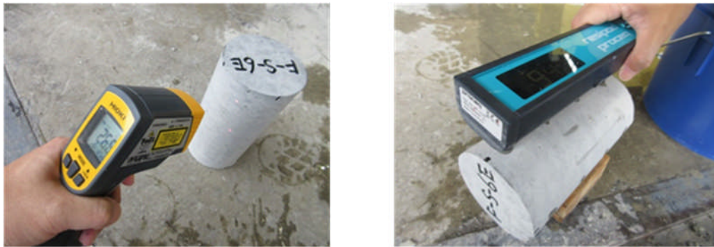
図-6.8 試験体の温度および電気抵抗率測定状況
