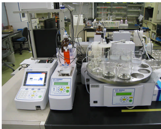
図-3.8 自動滴定塩分分析装置を使用した試験状況
