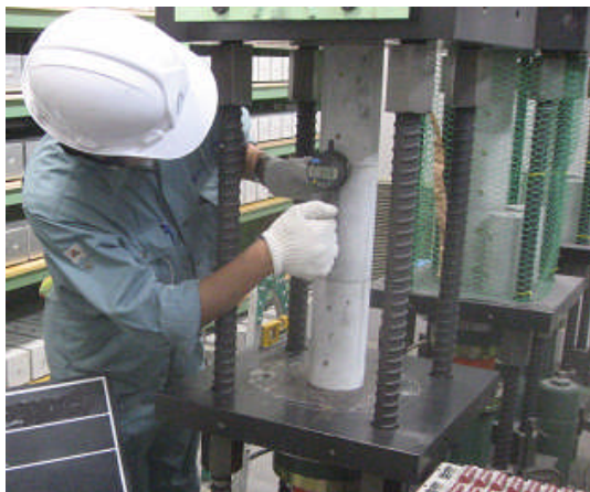
図-5.35 クリープひずみの測定状況
