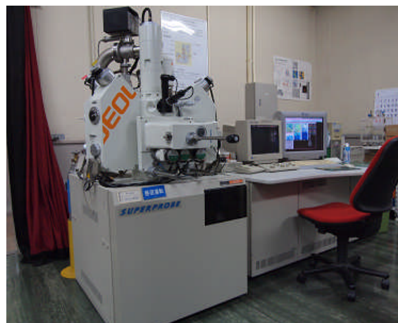
図-3.10 EPMAを使用した試験状況
