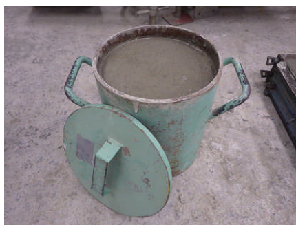
図-5.10 ブリーディング試験状況
