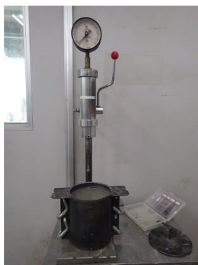
図-5.12 凝結試験状況
