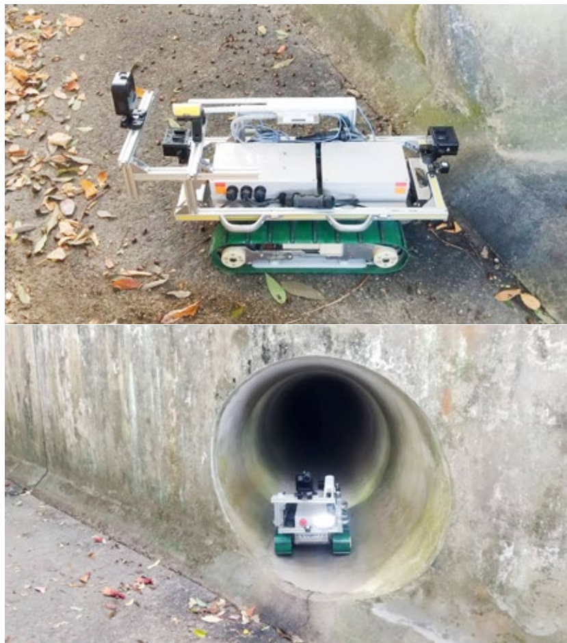
図1 検証用点検ロボット外観（上）、カルバート投入時の様子（下）
