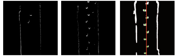
図2 二次元測域センサによる歩幅と歩隔の算出
