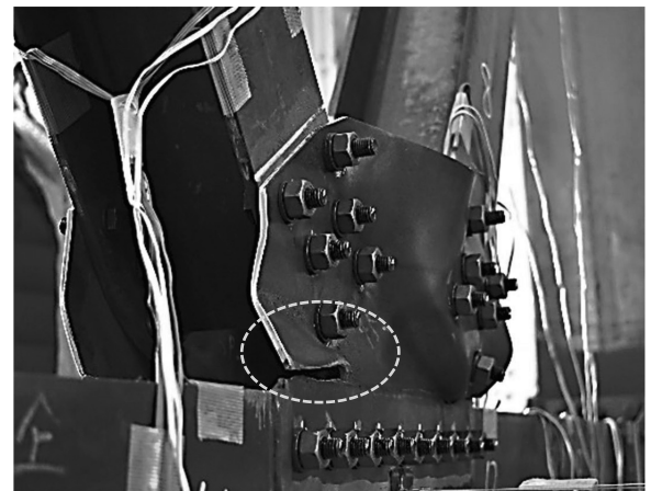
(b)ガセットプレートの破断 写真-2 実験結果(実験終了後)
