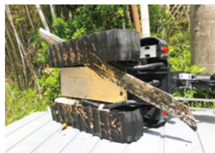
図3：2020/4/7検証評価に用いた点検ロボット（左：外観、右：金属片が混入した様子）
