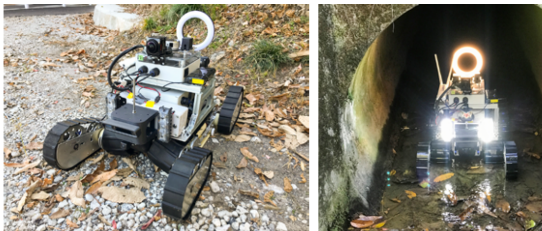
図5：2020/11/27検証評価に用いた点検ロボット (左：外観, 右：走行中の様子)
