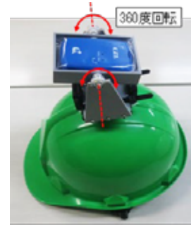
図 3 準天頂衛星受信機のヘルメットへの装着状況
