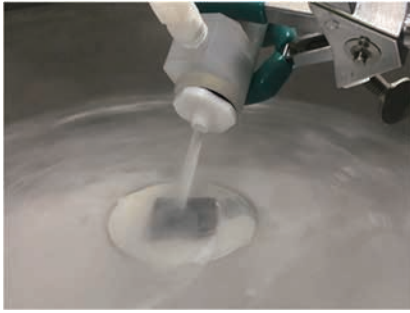
図3 超音波振動体型洗浄装置での洗浄の様子
