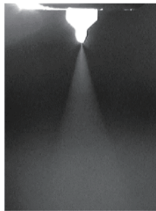
図1 エレクトロスプレーでの散布様子(9kV, 0.1mL/h)
