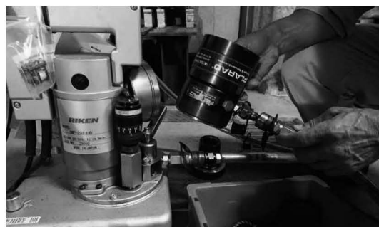
[写真4] 油圧ホースの繋ぎ
