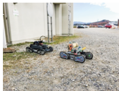
図1：左 調査ロボット（4号機）、右 ケーブル敷設ロボット（2号機）
