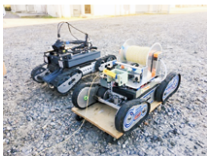
図1：左 調査ロボット（4号機）、右 ケーブル敷設ロボット（2号機）
