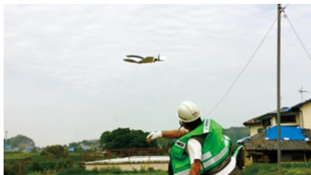
図2 熊本地震の被害調査で実働する固定翼機
