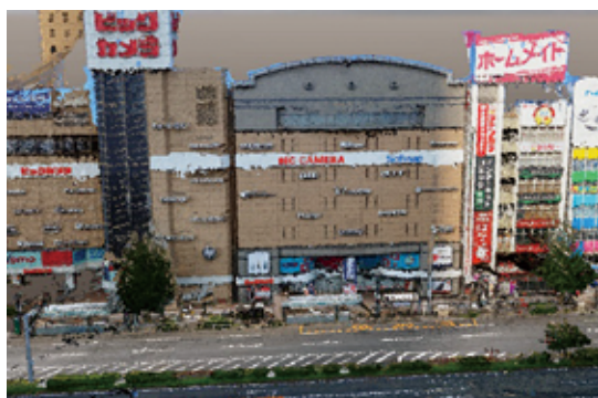
図3 生成された写真点群
