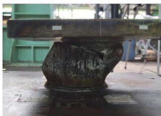
写真-1 頭部固定有り 試験後変形状況
