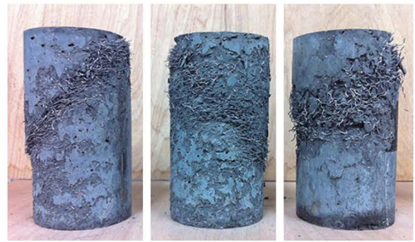
左から (a) 繊維長さ20mm[図-4(a):軟化型] (b) 繊維長さ20mm[図-4(a):塑性型+軟化型] (c) 繊維長さ40mm[図-4(c):塑性型]
