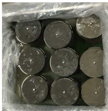
写真 3.5 コンクリート供試体の促進養生の状況
