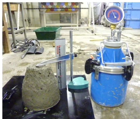
写真 6.1 コンクリート練混ぜおよびフレッシュ性状の試験状況
