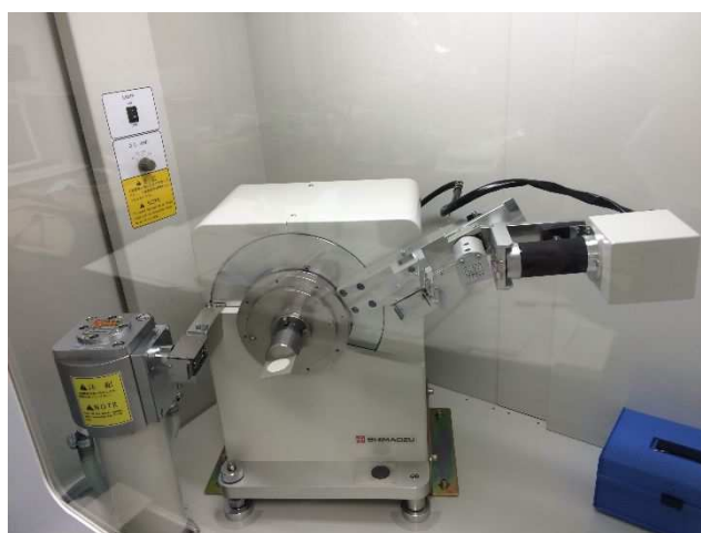
写真 2.2 X 線回折装置を使用した試験状況
