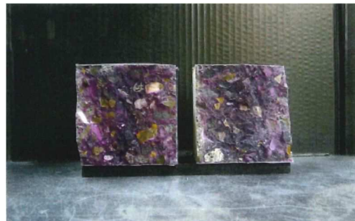
HBF-heat (初期材齢時に給熱養生)
