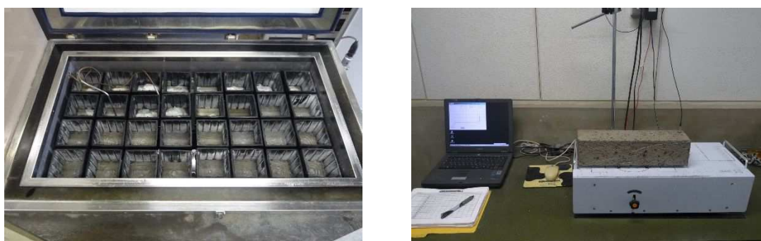
写真 5.3 コンクリートの凍結融解試験の試験状況
