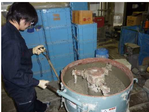
写真 6.1 コンクリート練混ぜおよびフレッシュ性状の試験状況
