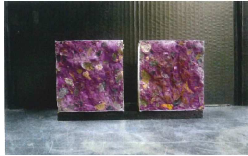
H-heat (初期材齢時に給熱養生)
