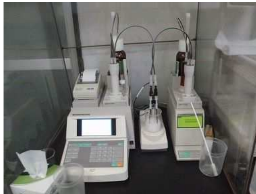
写真 4.4 塩分量分析装置および試験状況
