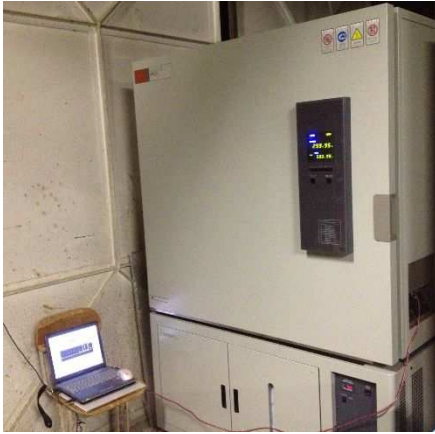
(1) 温湿度の制御ができる養生槽
