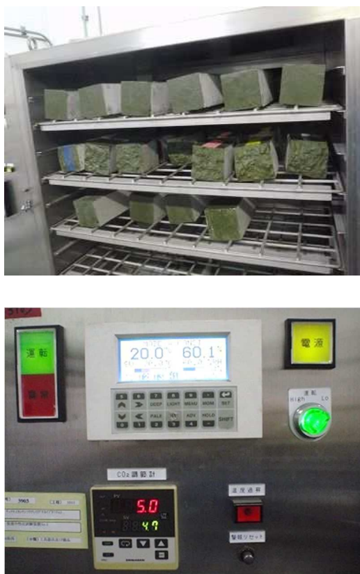
写真 5.1 コンクリートの促進中性化試験の試験状況
