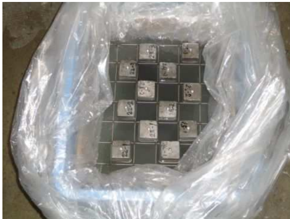
写真 3.3 モルタル供試体の ASR 促進試験 促進養生の状況
