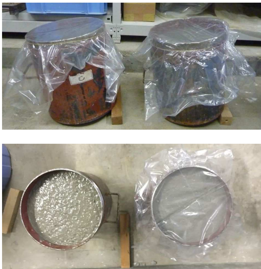
写真 6.3 ブリーディング量の試験状況
