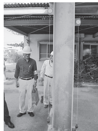
図1 下げ振りによる傾斜測定
