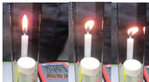
図1 2枚の電極間(3.5cm)のローソクの炎に高電圧(左の電極に正の電圧)を印加した場合における炎の形状。左:電圧0V、中:2kV、右:3kV。電極間に流れる電流は10M \Omega の抵抗の両端の電圧をテスターで測定することによって得た。
