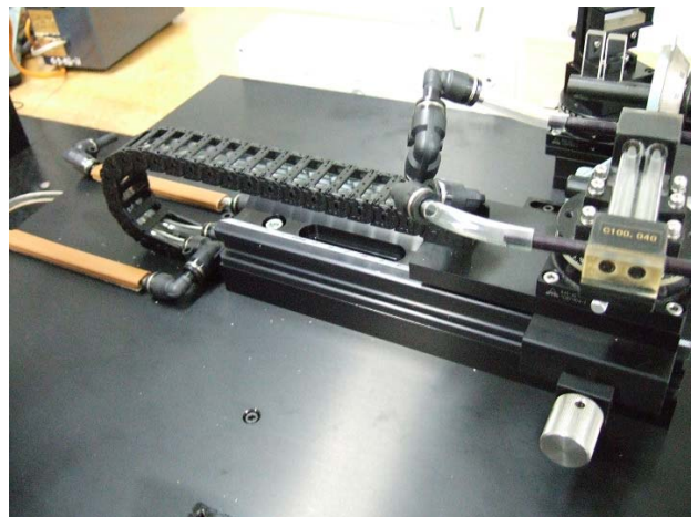
図 7 改良後の真空配管
