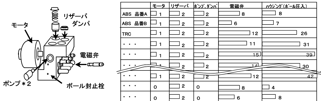
図 2-15 ABS アクチュエータの構造と部品構成 (山崎ら[2004])
