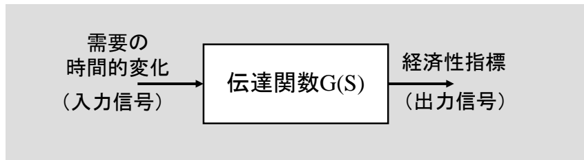
図 3-1 生産システムを制御系に見立てた場合の模式図
