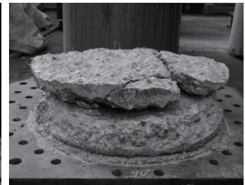
(d) C1.5-T9.0 二層のひび割れ
