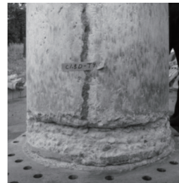
(c) C1.5D-T9.0 コンクリートの損傷 (ジベル無し)
