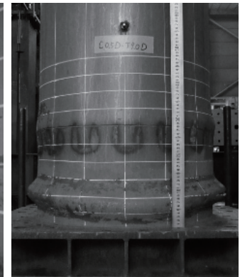
(b) C0.5D-T9.0D ジベル溶接位置に生じた座屈
