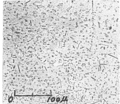
写真8 フジタックのコロナによる結晶の析出 15KV60分
