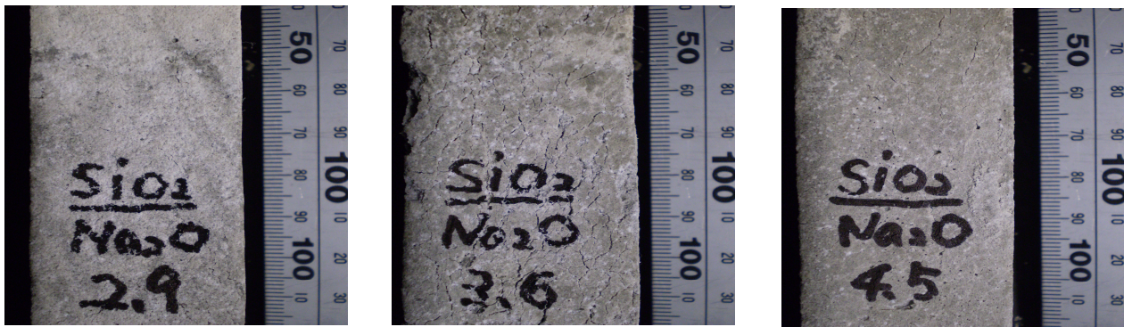
写真 5 膨張率測定用モルタル(Na 2 Oeq 0.55%)で確認した生成物の状況(貯蔵 1 年) (左: SiO 2 /Na 2 O, 2.9, 中: SiO 2 /Na 2 O, 3.6, 右: SiO 2 /Na 2 O, 4.5)
