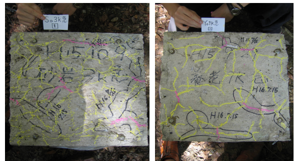
写真 3 コンクリート立方体のひび割れ状況 (左:カレット 3\text{kg}/\text{m}^3 、右:チャート Yo 9\text{kg}/\text{m}^3 )
