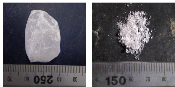
写真 1 反応生成物の代替として使用したカレット (左:破碎前、右:破碎後)
